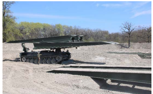
Der Brückenlegepanzer Biber legt das zweiteilige Brückenelement über eine Grube. (Fotos: Christian Kunerl)
