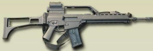
Aufschießender indirekter Gasdrucklader, Tragebügel mit integriertem Reflex (Hauptkampf)-visier bis 200 Meter, ZF 3-fach mit Strichplatte
