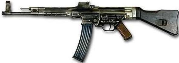
Gasdrucklader mit aufschießendem Verschluss, vollautomatische Waffe für Einzel- und Dauerfeuer. 150 Schuss wogen nur 2,9KG (3,9KG 8x57). Bis Kriegsende wurden 420 Tsd. Stück produziert.
