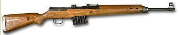
Aufschießender Gasdrucklader mit Stützklappen
