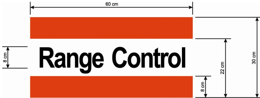
Abb. 16: Kennzeichnung der Schießsicherheitsfahrzeuge Typ A und Typ B
