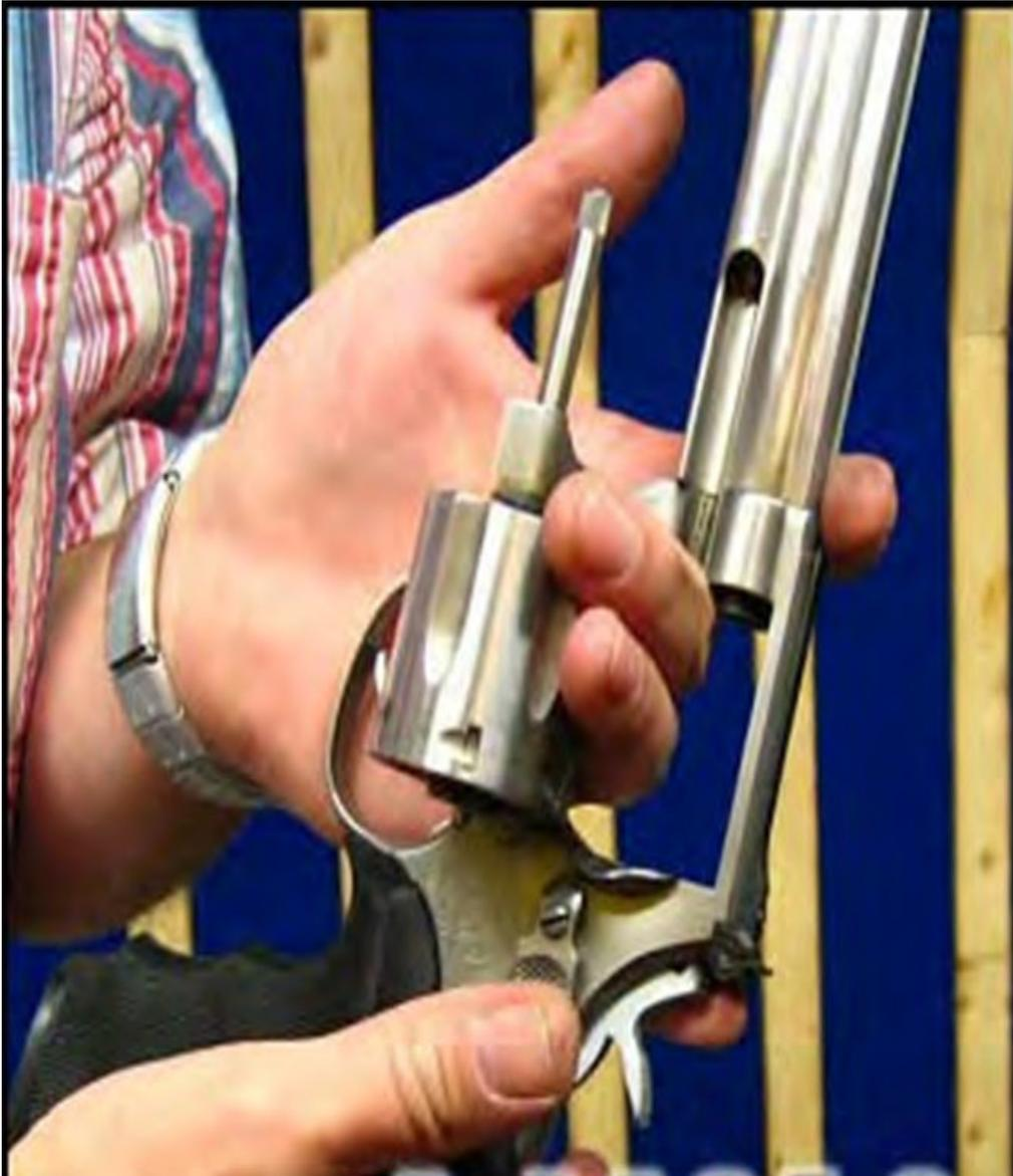
Da leere Hülsen aber meistens etwas festsitzen, sollte zum gänzlichen Entleeren der Trommel der Ausstoßer benutzt werden. Dazu wird die Stange einfach mit der flachen Hand nach unten gedrückt. Jetzt fallen auch feststehende Hülsen aus der Trommel.
