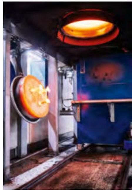
In einem speziellen Ofen werden die Rohre für die Gewehre gehärtet.
